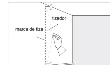
Luego se pone un clavo en la marca de abajo, se saca el plomo y se amarra una lienza con tiza (ver tizador) a ambos clavos. Se tenza, y luego se tira y se suelta la lienza para que la tiza marque la vertical.
