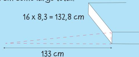
Pide en el Servicio de Dimensionado los cortes de la madera. El terciado moldaje de 15 mm hay que pedirlo dimensionado en 1 cubierta de 80 x 133 cm, para los laterales 1 trozo de 133 x 26 cm, para las costillas 2 trozos de 106,5 x 16,5 cm y 1 trasera de 80 x 14 cm. Y además hay que cortar tablas de pino cepillado de 2x1" en 23 travesaños de 24,6 cm que da un total de 132,8 pero lo cerraremos en 133 cm como largo total.
